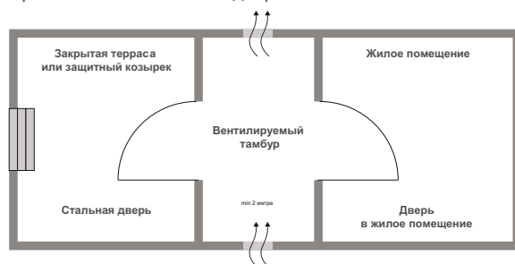
Схема 1. Требования для установки двери в коттедж, частый дом или офисное помещение (на улицу)
